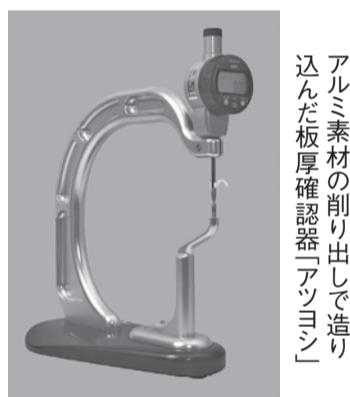
アルミ素材の削り出しで造り込んでいる。軽量かつ頑丈で鋲びにくいなどの利点があり長年使用できる。より精度の高い測定の必要な品質保証、測定部署に推奨できる。
