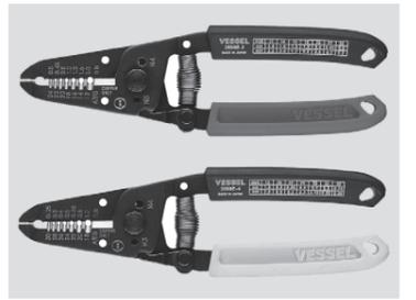
を2機種の発売を開始した。従来品に比べ、握る手にやさしいクッショングリップを採用、落下防止コードを取り付けできる穴付き、M3とM4の小ネジを切断できるカッター機能を追加した。
