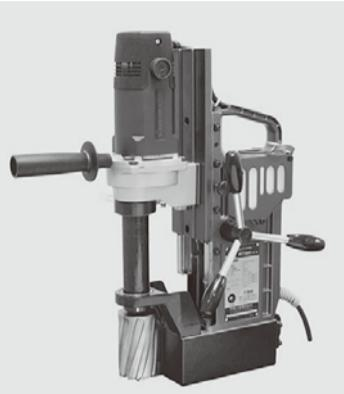
さらに、従来のアトラエースシリーズは、切削油タンクが本体の外側に付属していたが、「A-5500」は、タンクの破損を防止するために切削油タンクを本体内蔵している。全幅も 200mm 以下でスリムとなった。また、重さ 17.5kg の軽量設計(従来製品 A-5000 との比較で 20% 軽減)、そして電源を AC100V 仕様としたことで工場および現場作業での使いやすさを追求している。標準価格は 498,000 円(税別)。
