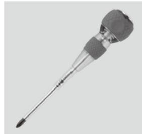
ボールの素材に高剛性・高摩耗性があるジルコニアセラミックを使っているため、ハンマーで叩いても割れる心配がない。グリップはサックに入れやすいテーパー形状。電気工事のハツリ作業、配電盤、端子台のネジ外しに適しており、刃先にはメッキの厚みの影響を受けないブラックポイント加工を施した。
