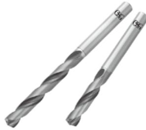
新製品ステンレス用油穴付き超硬ドリル「WDO-SUS-3D/5D」は、これらのトラブルを解決。切りくずを細かく分断する新型溝形状を採用。被削材と摩擦する面積が減少し、マージン部で発生する摩擦熱を低減する特殊マージン形状を採用。大きなバクテーパー、クーラント排出量が増大し、切りくず排出性を向上させ切削熱を素早く除去する新型オイルホール形状『MEGA COOLER』を採用している。
