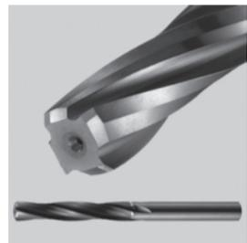
特徴としては高硬度材の穴仕上げリーマ加工における、切れ刃欠損、リーマ本体の折損、穴精度不良、短寿命等の問題点解決目的にて、各刃先諸元を最適化し、切れ刃欠損、本体折損を抑制し且つ穴精度を向上させ、更に高硬度材加工に最適な新超硬材種を採用することにより長寿命化を実現したことにある。
