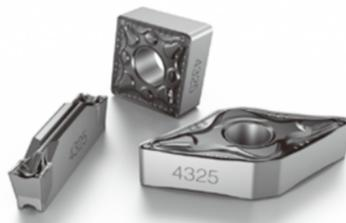
GC4325に代表されるGC4300シリーズは、革新的コーティング技術であるInveio™(インヴェイオ)コーティングを採用した、次世代の鋼旋削用材種である。アルミナ結晶を一方向に揃える技術により、コーティングの強度と耐熱性を飛躍的に高めている。さらに刃先処理精度向上による寿命のばらつき低減や、幅広い適用範囲によるチップ在庫の削減など、鋼加工の生産性を飛躍的に増加させる製品である。
