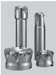
近年、エネルギー産業を中心にステンレス鋼や超耐熱合金等の難削材の使用量が増加してきている。難削材のミリング加工においては、ラジアスカッタが使用されるケースが多いが、工具寿命の改善が課題であった。MRW型は「両面八コーナー仕様」、「ヘリカル切れ刃設計」および「切り込み量に応じた最適切れ刃設計」の採用により、従来のラジアスカッタの課題を解決し、難削材加工の生産性向上に貢献する。
