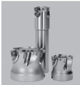
MFH型では従来平面形状であったチップの切れ刃形状を三次元凸型切れ刃に改良することで、ワーク食いつき時の衝撃を抑制し、耐ビビリ性能を大幅に向上させた。
