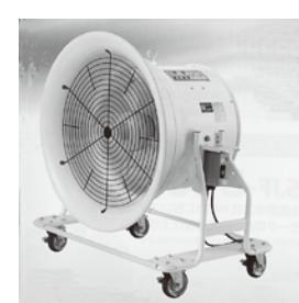
「SJF-604A」は、スイデンの新技術で、風の流れをスムーズにする拡管構造である「VF DESIGN」により余分な旋回流（風の渦）をなくし、スムーズな風の流れを生み、従来機比10dBの低騒音化と最大23%の省エネ化を実現した。（3相200V 50Hz時）
