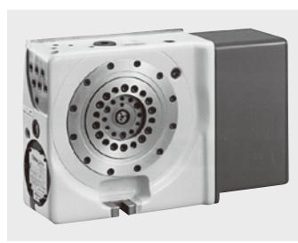
▽ブロックレス構造ロータリジョイント（CK R160の場合）。7ポート対応（空圧／油圧）=オプションで内蔵ロータリジョイントを設定出来る。従来のような外付けブロックがないのでロータリジョイント付きでも胴厚99mmのままで、横置きも可能。ポート数も7ポートと充実している。
