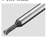
型材に対し、安定した効率のよいねじ切り加工を 行うことを目的としたねじ切り工具を開発した。 高硬度金型材に対し下穴なしで安定して効率よく ねじ切り加工を行えるため、従来の放電加工と比 較し高能率加工が可能となった。
