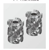
φ80の場合、切りくず量で500cc/minを超えるという、従来チタン合金の加工の常識では考えられないレベルの排出性能を有することが特徴である。また新開発したインサート材種「MP9030」との組み合わせで、大幅な工具寿命の延長を可能とした。
