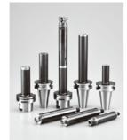
事を狙った工具である。その目的を達成すべく、 内蔵するダイナミックダンパーの最適設計技術を 開発した。
