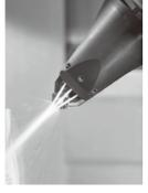
けるチップとワークとの接触面の温度が劇的に低 下する。また、これにより切りくずが分断されや すくなり、切りくず絡みが減少する。この結果、 良好な切りくず処理、仕上げ面、生産性の向上、 および長い工具寿命が得られる。
