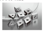
よって、研削から切削への置換が進んできた。近 年は、高精度な小物部品や複雑形状部品、難削な焼 入鋼に対しても切削化が望まれている。結合材組織 の抜本的改良で、より鋭利な刃先を生成し、耐摩耗 性を維持しつつ優れた耐欠損性を得ることができ、 従来比約2倍の工具寿命も達成。
